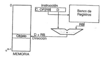
Este direccionamiento se diferencia del relativo a índice en que el registro de base no suele modificarse y el de índice sí. El direccionamiento es muy conveniente, por ejemplo, cuando se dispone de una zona de datos. Cargando en el registro base la primera posición de esta zona, se pueden alcanzar los distintos datos sin más que
