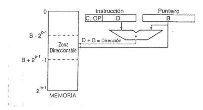
Evidentemente, mientras mayor sea la longitud p del desplazamiento D, mayor será el campo direccionable para un puntero determinado, pero más larga será la instrucción. Por ejemplo, el VAX permite desplazamientos de 8, 16 y 32 bits.
