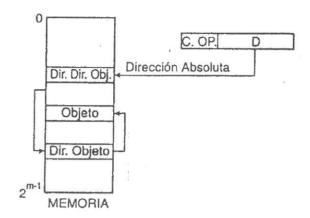
Una aplicación típica del direccionamiento indirecto consiste en el acceso a diversas informaciones mediante una tabla de punteros. En efecto, mediante un acceso indirecto, a través del elemento correspondiente de esa tabla, se puede acceder a la información deseada.
